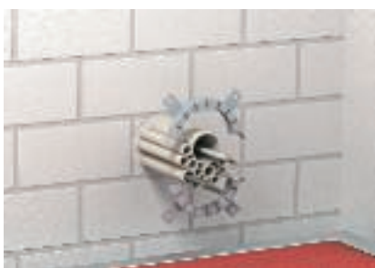
Spojení polovin manžety a upevnění na stěnu
