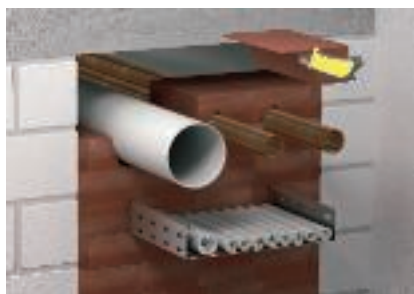
Prostup hořlavých trubek bez dodatečných opatření
