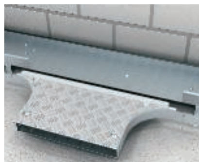
Montáž vestavného odbočného dílu Pro montáž vestavného odbočného dílu typu RAA se přeruší bočnice kabelového žlabu, vsune se a přišroubuje vestavný odbočný díl.
