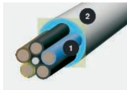
Průměr kabelu (1) a potřebné místo (2)
