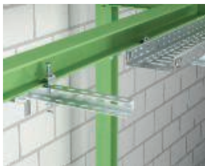
Krakorcový nosník na ocelové konstrukci Montáž profilu U jako krakorcového nosníku na ocelovém nosníku. Upevnění podle zatížení pomocí úhlových svorek nebo upínacích svorek. Upevnění rozpěrek typu DSK.
