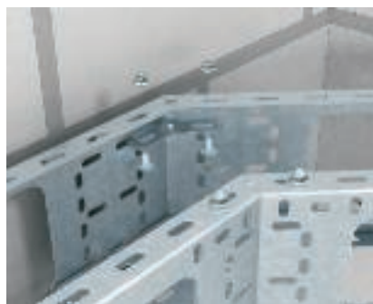
Úhlové spojení Jednoduché sestavení oblouků pomocí kloubových spojek typu SV. Bočnice se musí přitom odříznout.
