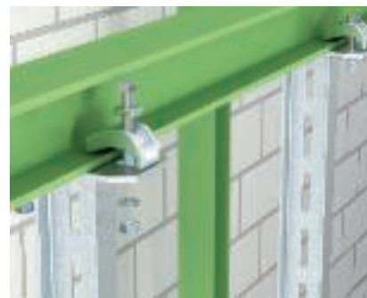
Závěsná konstrukce v oceli Závěsná konstrukce vhodná pro systém pro velká rozpětí, upevněná pomocí profilu IS 8 upnutého na ocelový nosník.
