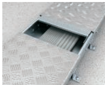
Montáž podpěry víka Montáž dodatečné podpěry víka ve středu kabelového žlabu pro dodatečnou stabilizaci víka od šířky 400 mm.
