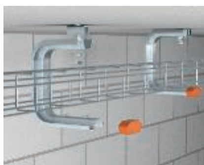
Montáž na strop pomocí nástěnného a stropního držáku TP Montáž mřížového žlabu G na strop pomocí nástěnného a stropního držáku TP typu TPDG. Upevnění mřížového žlabu na stropní držák se provádí bez šroubů.
