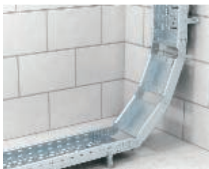
Montáž kloubového oblouku svislého, stoupajícího Kloubový oblouk svislý stoupací pro překlenutí výškových rozdílů nebo změně směru z vodorovného na svislý. Kloubový oblouk se upevňuje přímo pomocí kloubových spojek ke kabelovému žlabu.
