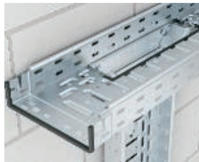
Montáž vestavného odbočného dílu Magic ve svislé poloze (pohled shora) Svislá montáž vestavného odbočného dílu jako odbočení podélné. Prostup v kabelovém žlabu se zhotovuje v místě instalace. Pro šířky > 400 mm objednejte spojovací materiál zvlášť!
