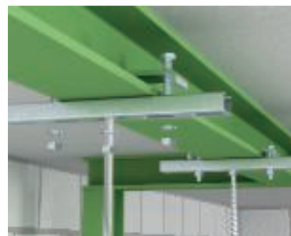
Upnutí profilové lišty C na nosník Upevnění profilu C typu CPS 4 G nebo CPS 5 G k ocelovému nosníku pomocí svěrných úhelníků typu KWS.
