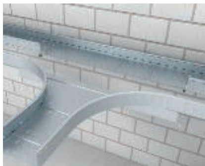
Montáž vestavného odbočného dílu Odbočný díl v kombinaci s kabelovými žlaby pro velká rozpětí. Bočnice se pro účely montáže vyřízne.
