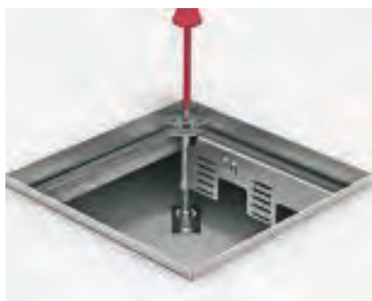
Nastavení výšky kazety Nastavte kazetový rám na horní hranu podlahové krytiny. Výškové nastavení nivelačních šroubů zajistěte kontramaticemi.
