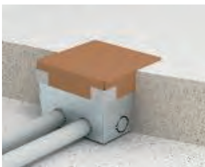
Práce s mazaninou Položte mazaninu a navažte ji na vestavnou jednotku. Nepoužívejte dělicí vrstvu.
