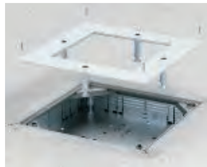
Příprava podlahového systému Namontujte montážní víko pro vysoká zatížení na podlahovou krabici. Nastavte výšku patek a zajistěte je kontramaticí.
