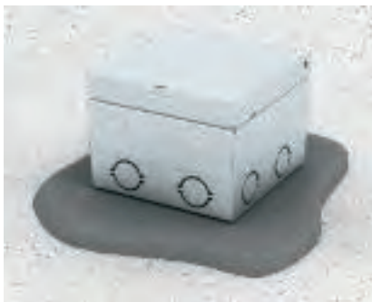
Přizpůsobení výšce mazaniny Při výšce mazaniny přes 95 mm zhotovte pod vestavnou jednotkou zatžitelnou vyrovnávací vrstvu.
