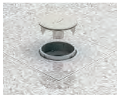
Montáž tubusu Vrchní díl tubusu vložte do uchycení tubusu a zapusťte jej. Otočením doprava tubus odjistíte a zavěte tak, aby lícovál s podlahou.
