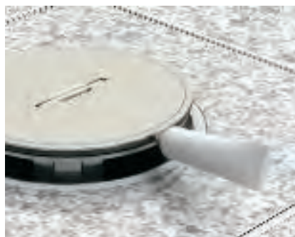
Čištění těsnění Po dokončení montážních prací vyčistěte vnitřek kazety a těsnění kazety i tubusu. Těsnění ošetřete vazelinou (součást dodávky).
