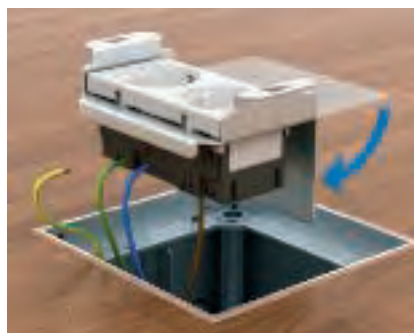
Montáž zásuvky do nosiče Naklapněte zásuvku do kovového nosiče a připojte ji. Po připojení vedení PE ohněte kovový nosič o 90 stupňů.
