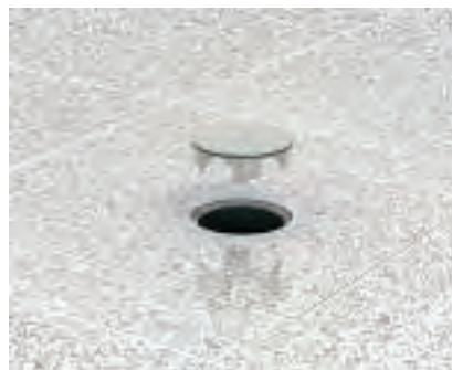
Montáž tubusu Vrchní díl tubusu vložte do uchycení tubusu a zapusťte jej. Otočením doprava tubus odjistíte a zavřete tak, aby lícoval s podlahou.
